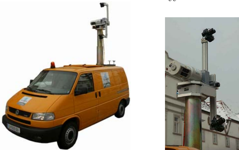
Abb. 1: CityGRID Scanner und Detail der Sensorik
