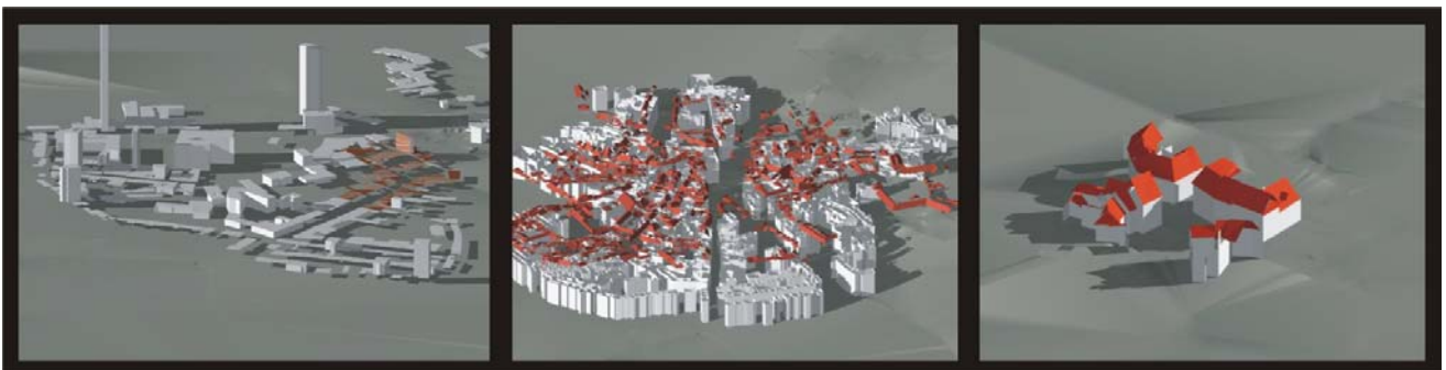
Abb.2: Mit DGM verschnittene Baukörper mit Verschneidungsfehlern, georeferenzierte Dächer und fertige Häusermodelle (eigene Darstellung)
